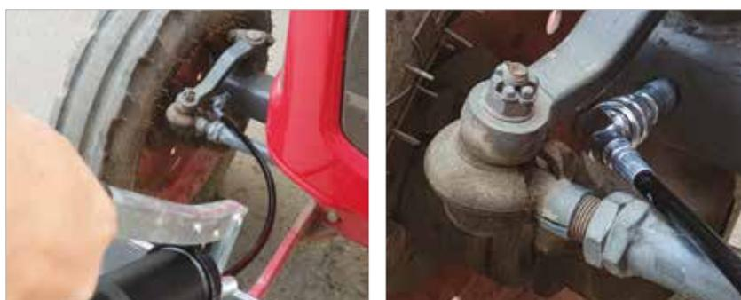
Comodo accesso a giunti di lubrificazione stretti e inaccessibili
