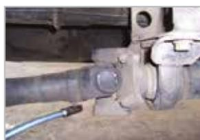
Giunto ad angolo retto utilizzato per lubrificare l'assale di un autocarro in cui l'accesso ai raccordi di lubrificazione avviene solo lateralmente
